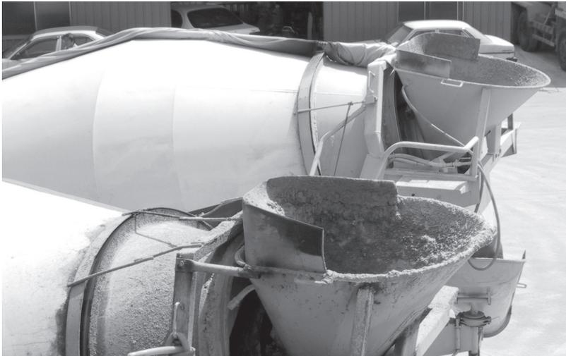
写真-1 アジテータ車のドラムに付着したコンクリート
