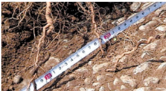
写真1 ポーラスコンクリートに貫入した植物根
