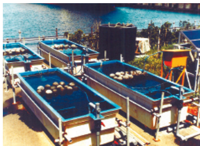
写真3 実海水を用いた実験水槽(1.3×1×0.7m)
